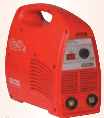
Ref. 9/423 INVERTER COTT 175SD SOLTER Intensidad 160 Amp. Rendimiento: 50% Electrodo de hasta 4 mm. TIG LIFT-ARC. Peso 3,9 kg. Doble ventilación. Válida para generador. Se suministra con maletín, conjunto pinzas y cinta transporte. Frontal SOLTER DIGITAL.
