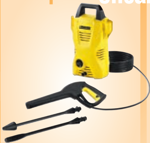
Ref. 9/309 HIDROLAVADORA KÄRCHER K 2 BASIC Caudal 360 l/h. Presión 110 bar. Potencia 1,4 KW. Rendimiento 20 m 2 /h. Manguera alta presión 3 m. Lanza turbo.
