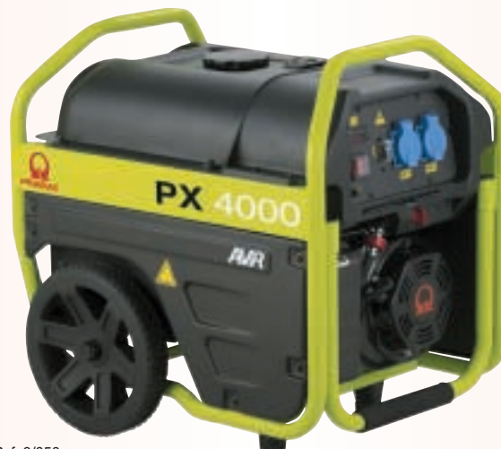
Ref. 9/356 GRUPO ELECTRÓGENO PRAMAC PX4000 3000 W. de potencia máxima, 230 V., arranque manual, con motor PRAMAC de 208 cc., depósito metálico de 18,5 l. AVR, panel de control con cuentahoras, voltímetro y frecuencímetro, 2 tomas de corriente. Kit de ruedas montado e integrado en carrocería.
