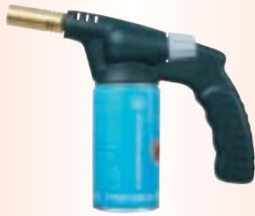
Ref. 9/361 SOLDADOR TH 2000 COLEMAN Potencia 2450 W. Consumo 175 g/h. Asa ergonómica. Cartucho CG 1750 incluido (no incluye cartucho CG 3500). Ajuste de la llama con una mano. Boquilla de origen, Ø21 mm.
