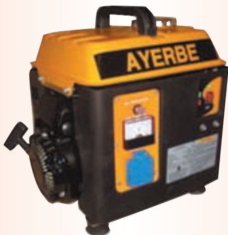
Ref. 9/075 GENERADOR AY-1000 KT AYERBE Potencia máx: 1 KVA. Nominal: 0,9 KVA. Motor 4 tiempos. Tensión: 230 V / 50 Hz. Consumo: 0,8 l/h. Depósito 3,5 l. Nivel sonoro: 94 dB. Alarma de aceite. Medidas: 365x320x405 mm. Peso 23 kg.
