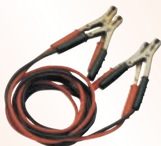
Ref. 9/150 CABLE DE ARRANQUE AUTOMÓVIL SALKI COMERSIM 80 Amp. Pinzas aisladas de latón fundido. Longitud: 3 m. De cobre. Sección 6 mm 2 .
