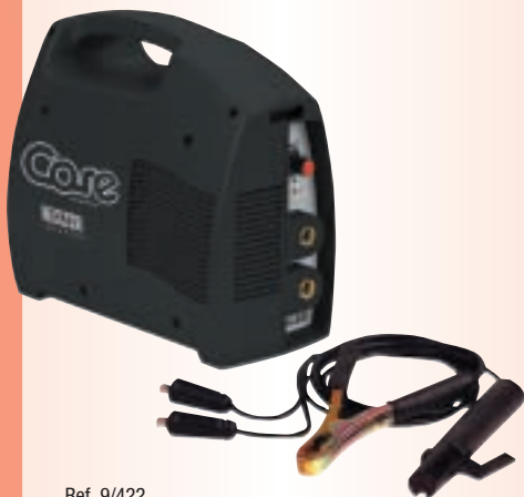
Ref. 9/422 INVERTER CORE 1600 SOLTER Intensidad máx.120 Amp. Rendimiento: 45% a 20°C. Peso 3,5 kg. Válida para generador. Se suministra con pinzas.
