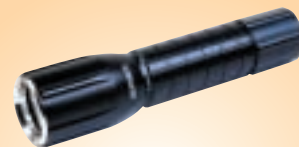
Ref. 9/204 LINTERNA LED PROGRAMABLE FEGEMU Inteligente smartTorch, programable mediante cable USB con un número ilimitado de modos posibles. LED CREE R3. 150 lúmenes. Hasta 93 h. de autonomía. Peso 136 g. Alcance 170 m. IPX7. Sumergible 1 m. Permite la codificación MORSE.
