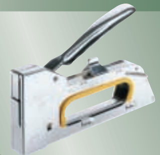
Ref. 9/184 CLAVADORA MANUAL R33 ESSELTE Profesional. Más de 100.000 grapados. Recomendada para sujetar tejidos, lienzos, piel, carteles, mallas, rótulos, etc. Fuerza regulable. Sin retroceso. Función de bloqueo. Cubierta y mecánica de acero. Ajuste máximo.
