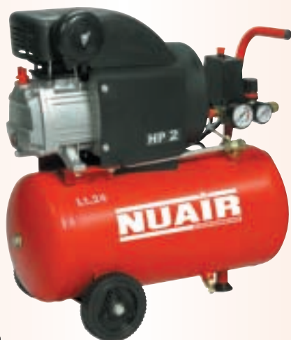
Ref. 9/009 COMPRESOR MONOBLOCK NUAIR RED LINE 2 HP 24 L. AIRUM 8 bar. 220 l/min. Monofásico. Cilindro hierro fundido. Lubricado. Versátil y sencillo. Ideal bricolaje.
